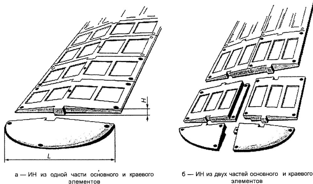
Рис. 3. Конструкция сборно-разборной ИН
