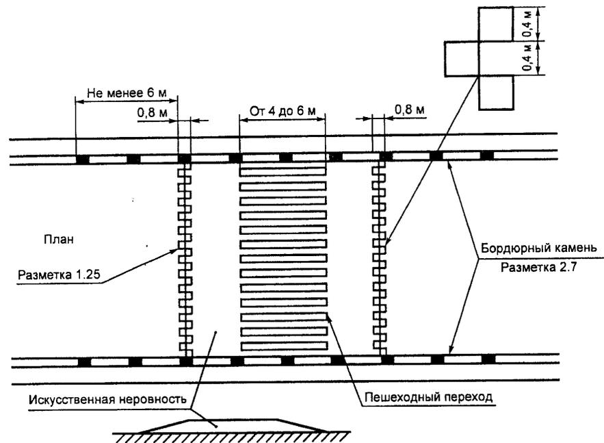
Рис. 5. Пример нанесения разметки 1.25 и 2.7 в случае возвышающегося пешеходного перехода, совмещенного с ИН
